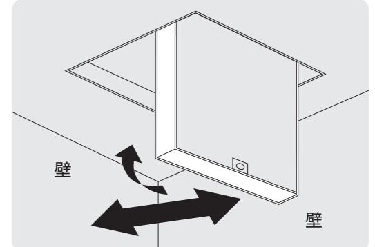
注) 壁を傷つけないように、内枠は壁と反対側に開くように取り付けてください。
