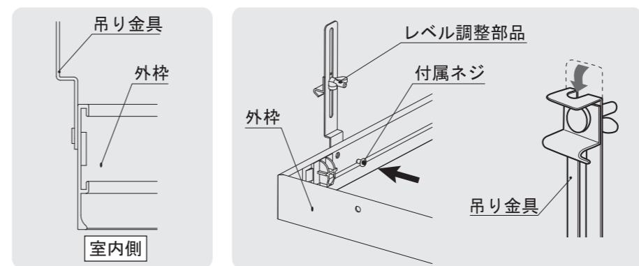
■ 外枠の取付方向確認後、吊り金具を内側から付属ネジで取り付けてください。 レベル調整部品の蝶ナットをゆるめチャンネルにレベル調整部品を引っ掛け、蝶ナットをしっかりと締め付けてください。
