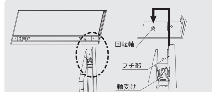
①内枠を外枠と回転軸との間から入れ、内枠のフチ部に回転軸が沿う状態で下方にスライドさせながら、内枠の軸受けに回転軸がカチッと音がするまで、はめ込んでください。
