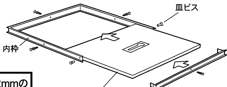
15mmの厚みのフタ板用です。床材が12mmの場合、3mmの板を合わせて施工してください。
