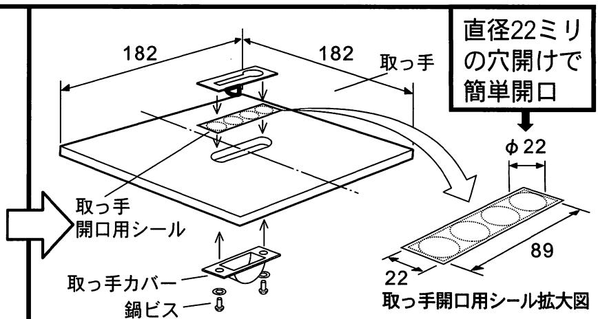
切抜いた床材を上記寸法に切斷し、取っ手開口用シールを貼って長丸を開口し、鍋ビスで取っ手を取付ける。(フタ板)
