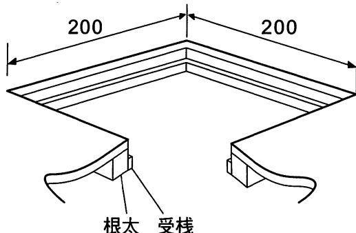
床面を開口し、開口部を根太で補強し、点検口の外枠を受ける桟を取り付ける。
